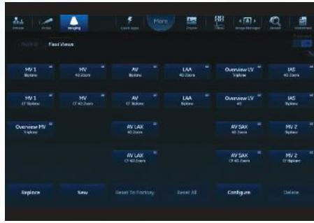
**FlexiViews<sup>3</sup>.** Быстрое переключение предварительно заданных проекций в режиме 4D и многоплоскостном режиме способствует сокращению времени сканирования во время сложных интервенционных процедур.
